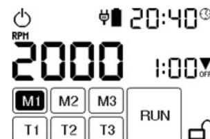
Na displeji je třeba dotykem stisknout tlačítko M1. Pomocí tohoto tlačítka se nastavuje aplikáční čas č. 1. Následně je třeba dotykem stisknout tlačítko zobrazující aplikáční čas (vpravo uprostřed na displeji, čásciíka OFF) a následně se zobrazí displej s číselnými možnostmi:
