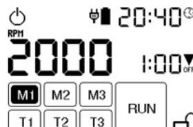
Berühren Sie die Taste M1 auf dem Display. Stellen Sie mit dieser Taste die Applikationszeit Nr.1 ein. Drücken Sie dann die Taste, die die Anwendungszeit anzeigt, (rechts in der Mitte des Displays Zeitpfeil OFF) und dann wird das Display mit den numerischen Optionen angezeigt:
