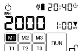
In der Werkseinstellung des Gerätespeichers sind die unten stehende Drehzahl und die Applikationszeit eingestellt:
