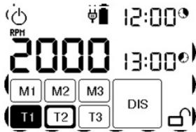
Al pasar el intervalo de 5 minutos durante los cuales el dispositivo PrimerCube estaba inactivo, el dispositivo pasa al modo STANDBY, o sea el modo Sueño. En este modo desconectado, la batería interior plenamente cargada se mantendrá aproximadamente 1 mes. Los programas preajustados permanecen en la memoria del dispositivo porque EEPROM memory / memoria no depende de la actividad de carga de la batería.
