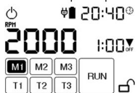
Pulse el pulsador M1 en la pantalla. Este pulsador se utiliza para configurar el tiempo de aplicación No. 1. Luego hay que pulsar, por contacto, el pulsador que muestra el tiempo de aplicación (a la derecha, en el medio, en la pantalla „flecha de la hora OFF“) y seguidamente se muestra una pantalla con opciones numéricas:
