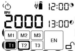
Die Deaktivierung dieser Funktion - Timer - kann durch Drücken der Taste DIS eingestellt werden. Nach der Deaktivierung wird der T1-Wert ohne Umrandung in einem kleineren schwarzen Würfel angezeigt.
