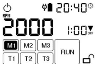
Нажать кнопку M1 на дисплее. При помощи этой кнопки осуществляется настройка времени работы №1. После этого нажать кнопку изображения времени работы (направо в середине экрана „время стрелка OFF“), после этого изображается цифровая клавиатура:
