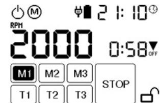
V případě, že uživatel chce program zastavit ještě před uplynutím zbývajícího aplikačního času, je třeba stisknout na displeji označení STOP.
