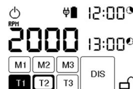
Настройка времени и ее загрузка в память осуществляется нажатием на изображаемое значение, и затем при помощи кнопок:
